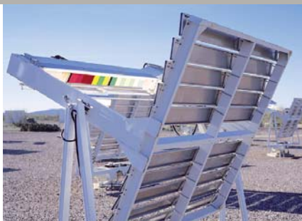
I campi di esposizione di Atlas material testing solutions
